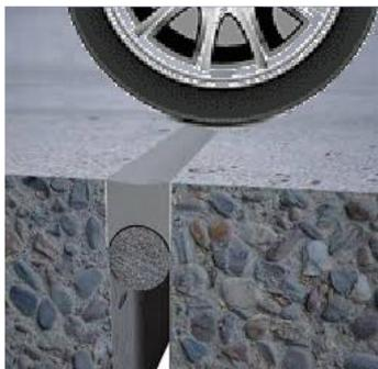
Juntas de dilatação horizontais resistentes ao tráfego
