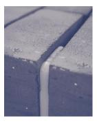
PENOSIL Fondo de junta PE 450 se utiliza como limitador de profundidad y como soporte de sellados de juntas de dilatación y juntas de estanquidad entre iguales o diferentes materiales de construcción.
