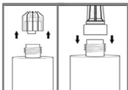
Desenroscar el tapón del cartucho y fijar firmemente la boquilla mezcladora.
