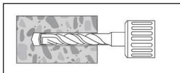
Perforar el orificio, con el diámetro y la profundidad correctos, utilizando un taladro percutor. Comprobar la perpendicularidad del orificio durante la operación de perforación.
