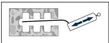
Limpiar el orificio del polvo de perforación, fragmentos de núcleo, aceite, agua, grasa y otros contaminantes, antes de la inyección de mortero (con soplador manual y cepillo manual estándar).
