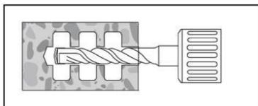
Taladrar el agujero, con el diámetro y la profundidad correctos, usando el taladro apropiado. Comprobar la perpendicularidad del orificio durante la operación de perforación.
