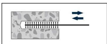
El orificio debe limpiarse por lo menos con 4 operaciones de cepillado seguidas por al menos 4 operaciones de soplado.
