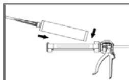
Asegurarse de que el elemento mezclador está bien situado e insertar el cartucho en la pistola dosificadora.
