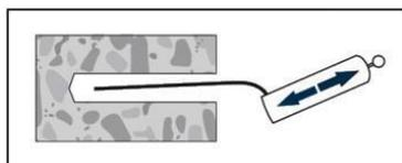
Limpiar el agujero del polvo de la perforación, de fragmentos, de aceite, agua, grasa y de otros contaminantes, antes de la inyección del mortero, con un cepillo manual, soplador y/o un cepillo de cerdas de acero.
