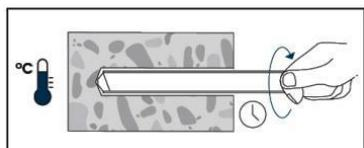
Insertar inmediatamente la varilla roscada, lentamente y con un ligero movimiento de torsión, retirando el exceso de mortero de inyección alrededor de la varilla roscada.
