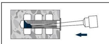
Llenar el tamiz uniformemente, comenzando desde el fondo. Retirar lentamente el mezclador, poco a poco, y extraer la cánula unos 10 mm para cada operación de prensado.
